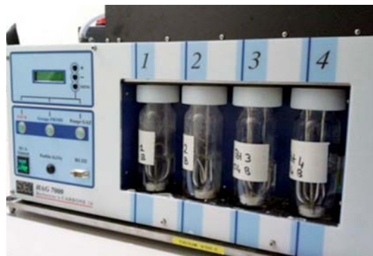
Dispositif de prélèvement du tritium gazeux par barbotage.
