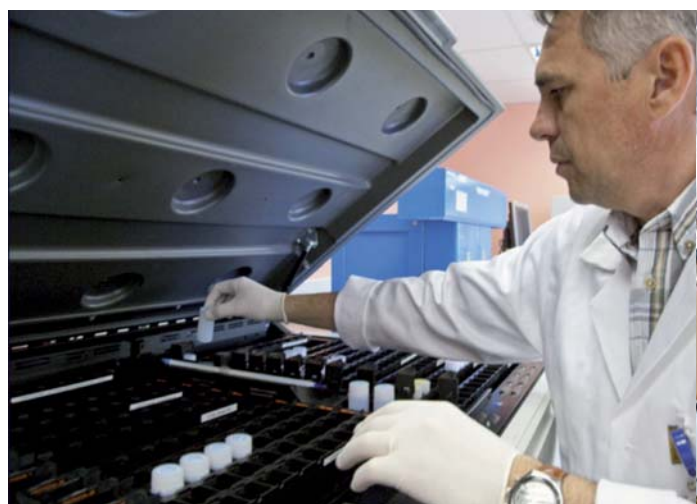
Mesure du tritium par scintillation liquide.
