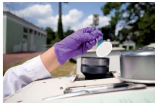
Prélèvements des aérosols sur filtre.
