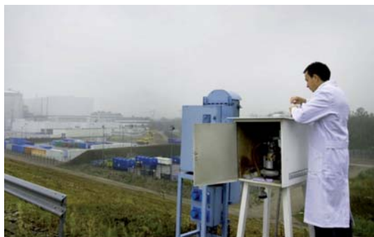
Station de contrôle des poussières atmosphériques. Centrale nucléaire de Fessenheim.
