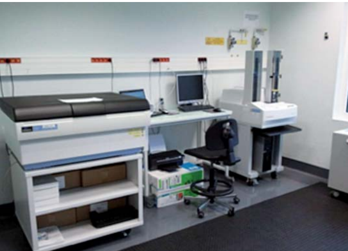
Scintillateur bêta pour la mesure du tritium (à gauche) et compteur proportionnel (à droite) au laboratoire « Effluents ».
