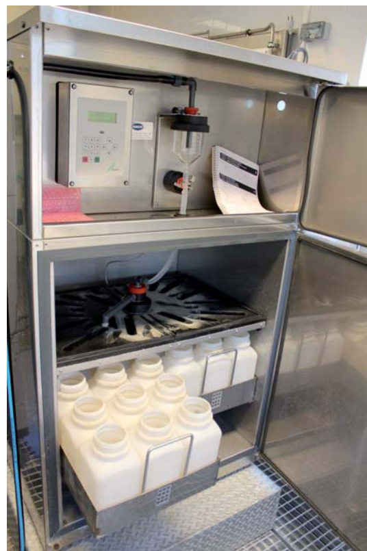
Hydrocollecteur pour les prélèvements d'échantillons à mi-rejet.
