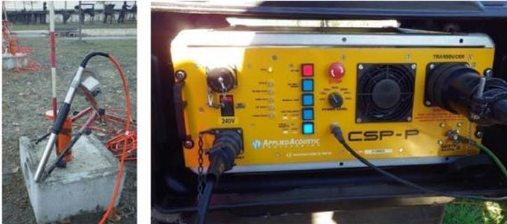
Figure 1.19 Illustration d'une source P : sparker (SolGéo).
