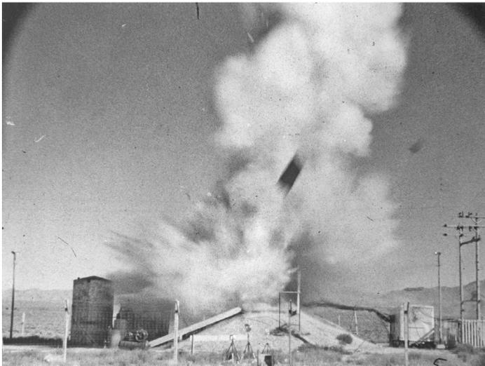
**Figure 8.3.** En haut, schéma du réacteur BORAX-1. © DR. En bas, photographie prise lors de l'essai destructif final du réacteur BORAX-1. © Argonne National Laboratory (*creative commons*).
