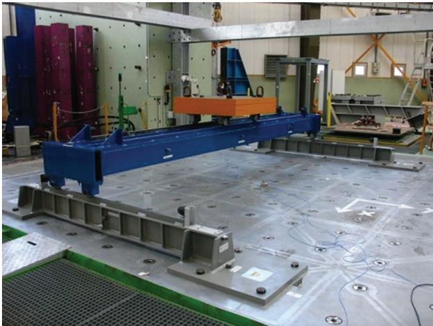
**Figure 7.10.** Pont de manutention testé sur la table vibrante AZALÉE du centre d'études CEA de Saclay. © CEA.
