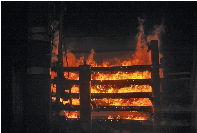
Figure 7.5. Une expérience de feu de chemins de câbles superposés. © Florent-Frédéric Vigroux/IRSN.
