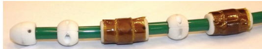
Figure 10.10. Prototype de sonde souple à courants de Foucault pour inspection de cintres de tubes de GV. © DR.
