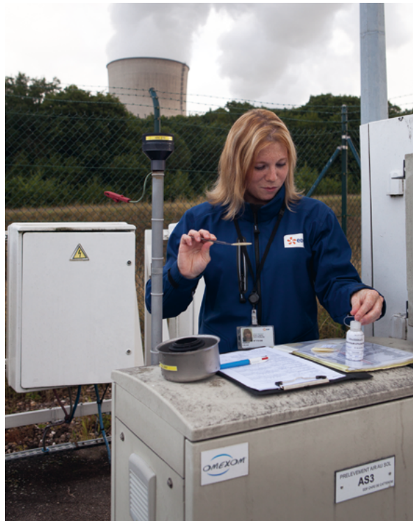
Prélèvements des aérosols sur filtre au CNPE de Cattenom © EDF – David Queyrel
