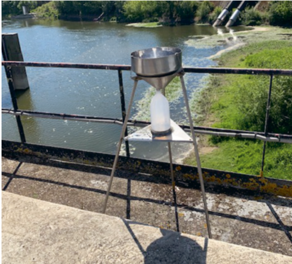
Préleveur d'eau de pluie installé aux abords du CNPE de Chinon © EDF – Dominique Jourdain
