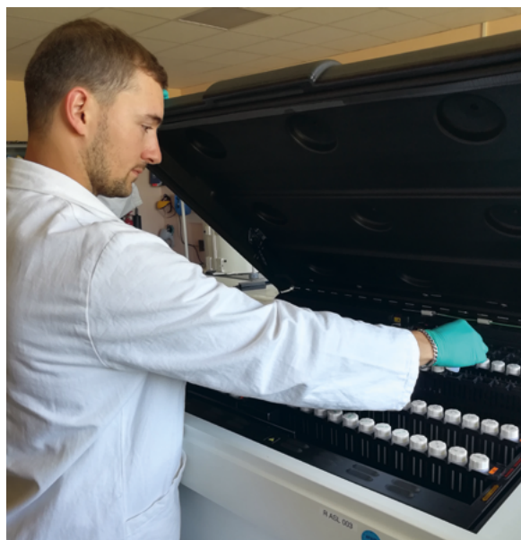
Mesure du tritium par scintillation liquide dans les laboratoires de la Direction Industrielle d'EDF © EDF – François Grateau
