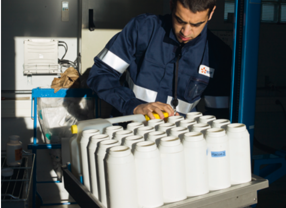
Technicien environnement à la station multiparamètres (SMP) située en aval du CNPE de Cruas-Meyssse préparant les bidons à placer dans l'hydrocollecteur pour la réalisation des prélèvements horaires réalisés dans le cadre de la surveillance des rejets d'effluents liquides dans le Rhône © EDF – Christel Sasso
