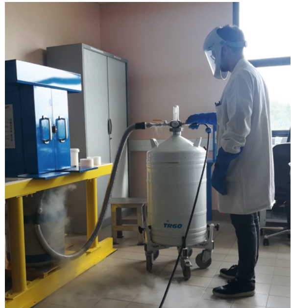
Remplissage de l'azote liquide nécessaire au fonctionnement du spectromètre gamma utilisé pour les mesures effluents © EDF - Pierre-Édouard Delbart
