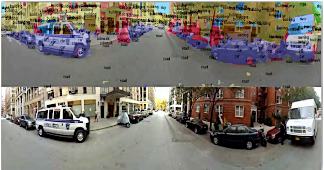
Figure 4 Véhicules autonomes : En bas, la vue « naturelle » et en haut, l'analyse de la même scène par le système de vision du véhicule autonome (Google Car)
