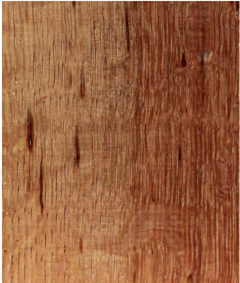
Quercus acutissima Longitudinal surface of wood
