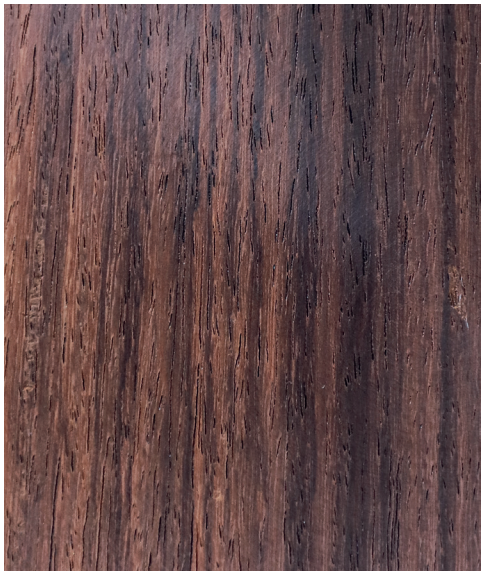
Dalbergia latifolia Longitudinal surface of wood
