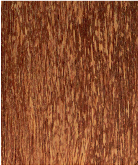
Cynometra malaccensis Longitudinal surface of wood
