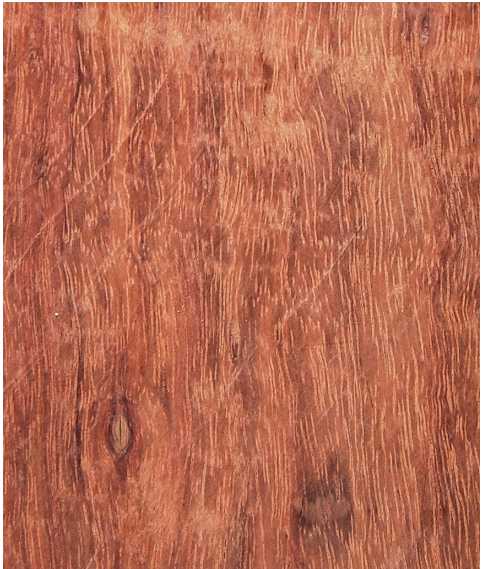
Platymiscium pinnatum Longitudinal surface of wood
