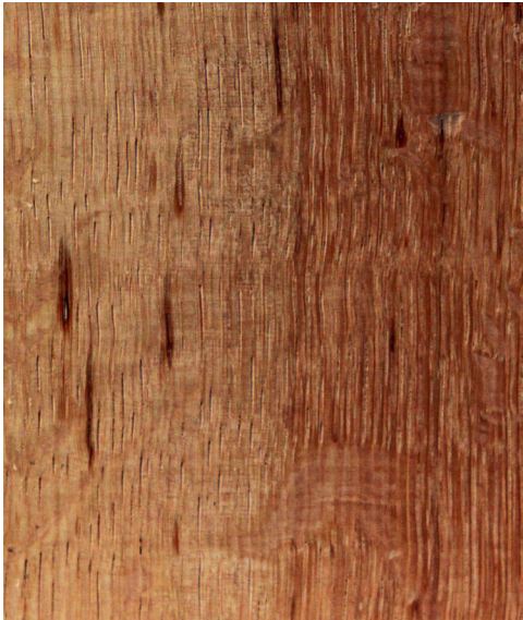
Quercus acutissima Longitudinal surface of wood
