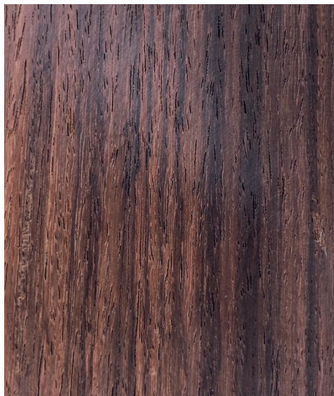
Dalbergia latifolia Longitudinal surface of wood
