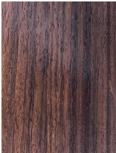
Dalbergia latifolia Longitudinal surface of wood
