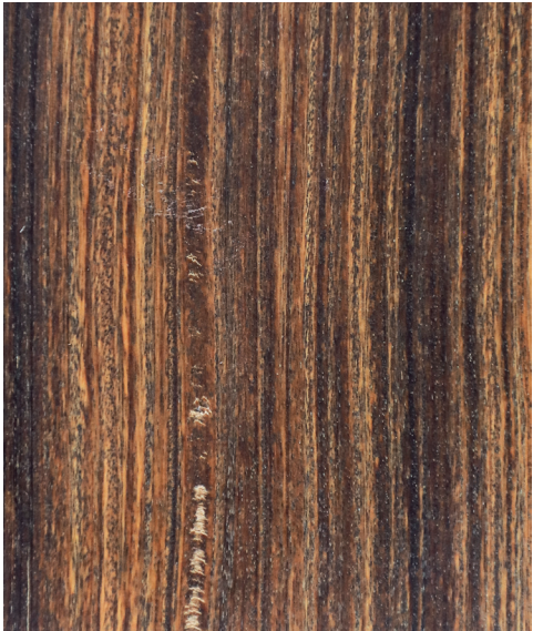
Guaiacum sanctum Longitudinal surface of wood
