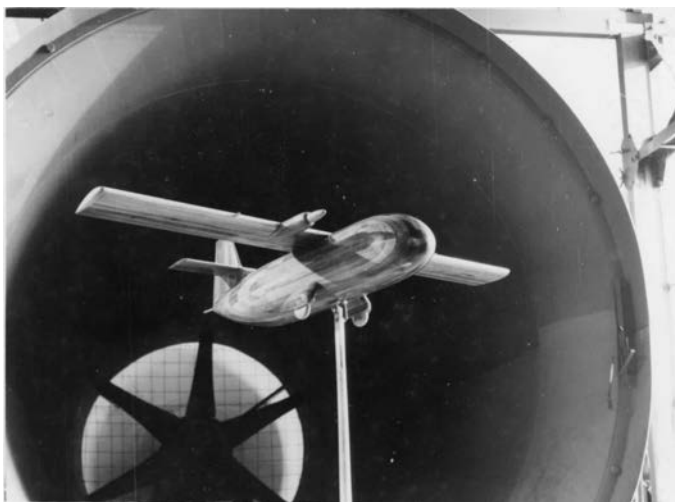
Figure 6.7 Maquette dans la veine d'essais de la soufflerie de Toulouse (diamètre 2,4 mètres), dans les années 1950, et au fond ventilateur d'aspiration de l'air (diamètre 4,6 mètres). Le ventilateur détruit en 1943 comportait trois pales en bois. Arch. IMFT.
