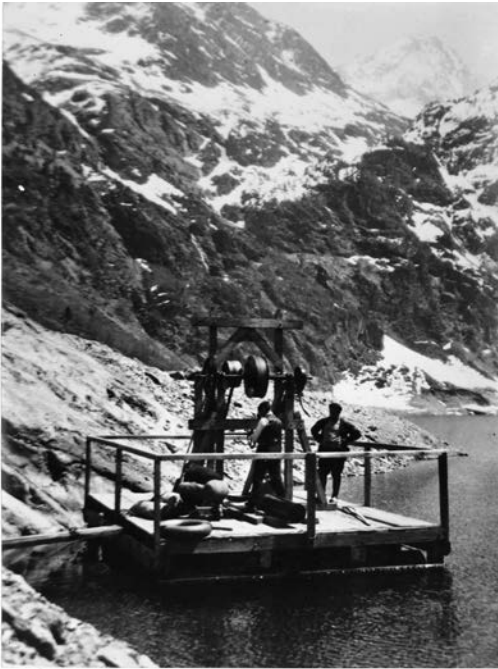
Figure 7.7 Radeau des expériences du lac d'Oô (80 mètres de profondeur) et schéma de la machine d'Atwood permettant la variation du poids apparent de l'obstacle (et donc de sa vitesse terminale) (Baubiach, 1936).
