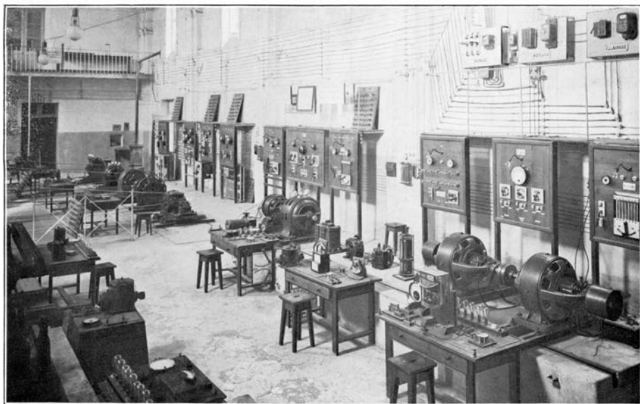
Figure 4.7 Salle des machines électriques des 2 e et 3 e années, côté réceptrices : moteurs à courant continu et à courant alternatif (asynchrones).
